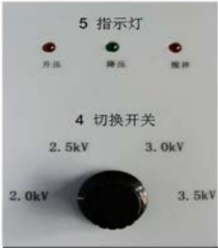
1. 液晶显示屏；2. 功能键；3. 打印机；4. 升压速率切换开关；5. 指示灯；6. 油杯仓盖； 7. 温、湿度传感器；8. 地线柱；9. 电源插口；10. 电源开关；11. 高压安全标志
