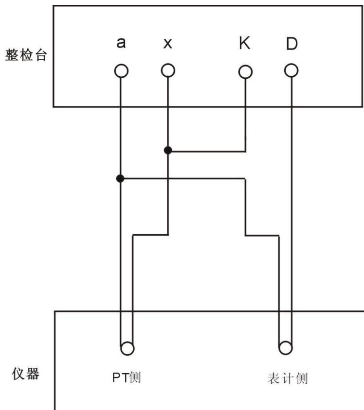
检定时可以使用互感器整检台，选择电压互感器测量回路即可。
